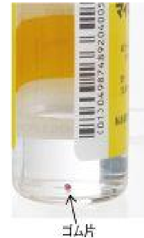
コアリングが起きた実際の写真 (テクネチウム調製用キット使用の手引きより)
